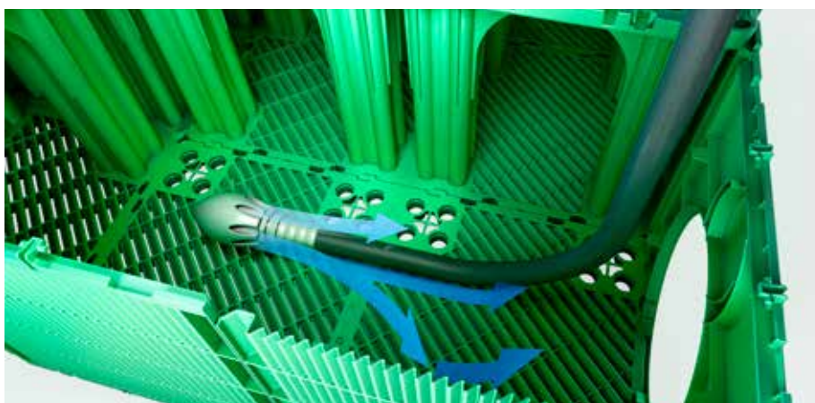
Smarta konstruktioner av sidopaneler och bottenplattor - lutande ribbor som under rengöring sprider vattenstrålen och förhindrar skada på geotextilen.
